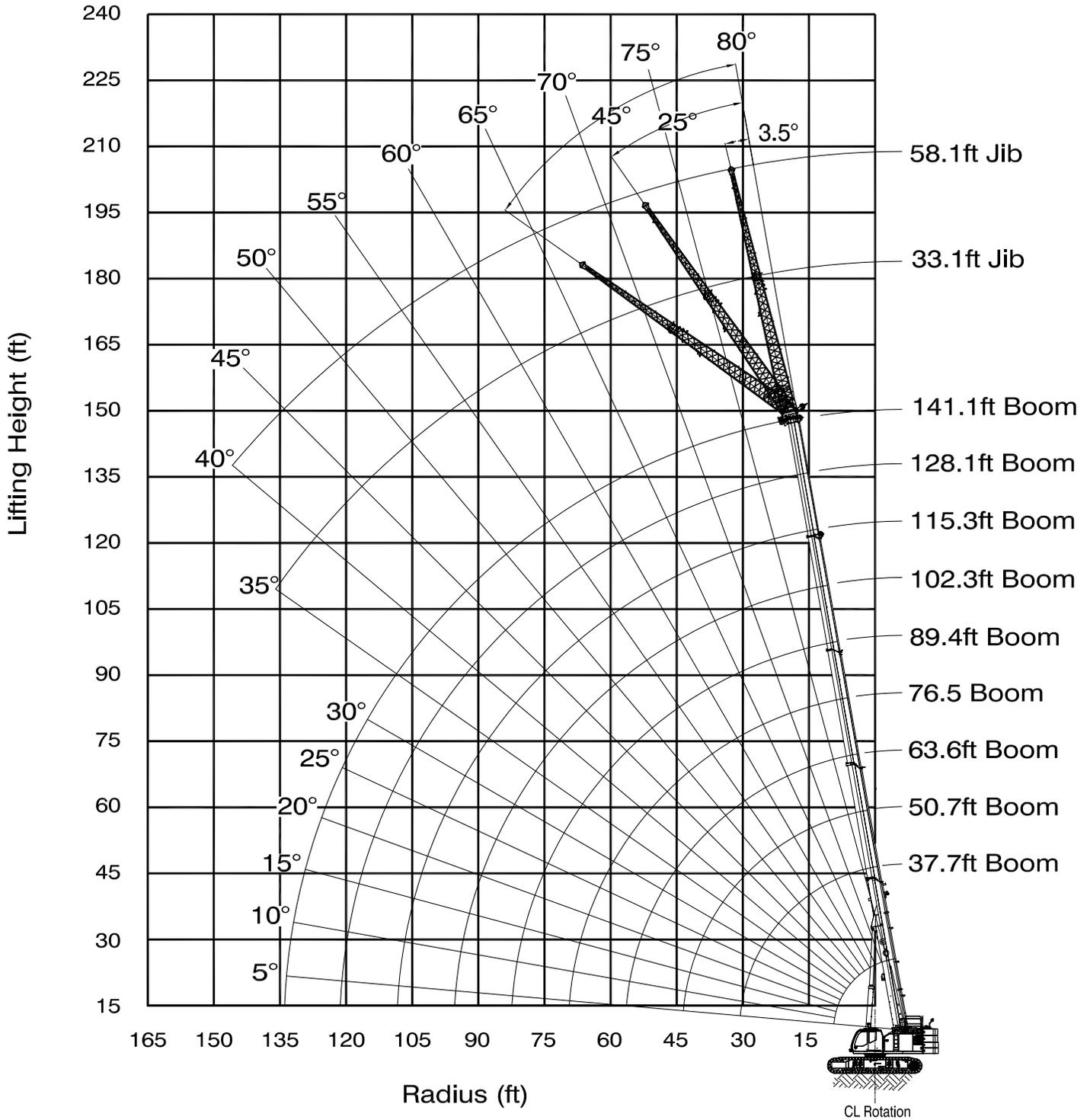
**WORKING RANGE DIAGRAM - HEAVY LIFT JIB**
